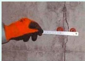
写真1 ひび割れ幅の計測
