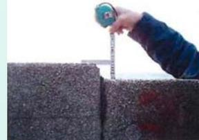
写真2 沈下量の計測
