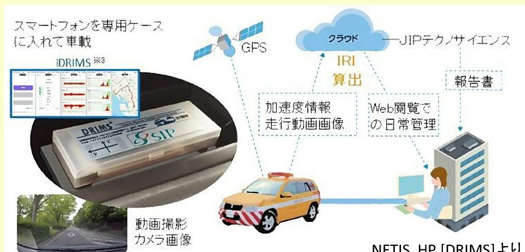
一般車両による路面性状測定方法に変えたことにより、日常的な路面測定・評価を行えることから、測定頻度・測定範囲の自由度が高まるので、施工性の向上が図れる
