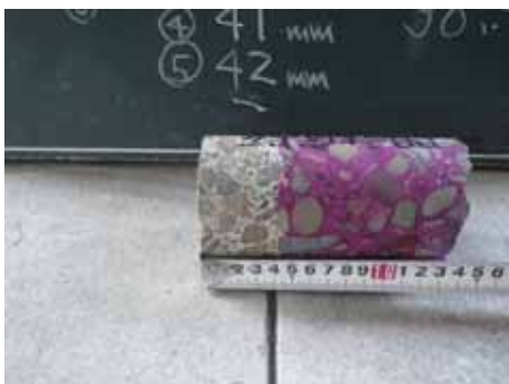
コアによる中性化試験
